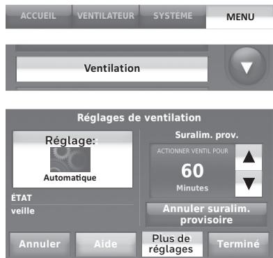
**REMARQUE :** Si le réglage est sur humidification en mode de chauffage, le ventilateur se met en marche pour retirer l'excès d'humidité si la valeur est supérieure de 10 % ou plus au réglage d'humidité.
