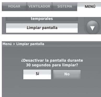
**NOTA:** NO rocíe ningún líquido directamente sobre el termostato. Rocíe los líquidos sobre un paño, después utilice el paño húmedo para limpiar la pantalla. Utilice agua o el limpiador para vidrios que utiliza en casa. Evite utilizar limpiadores abrasivos.
