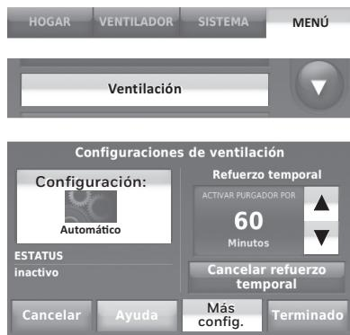
**NOTA:** si se ha configurado la humidificación en la modalidad de calefacción, el ventilador se encenderá para eliminar el exceso de humedad si esta se encuentra 10% o más por encima de la configuración de humedad.
