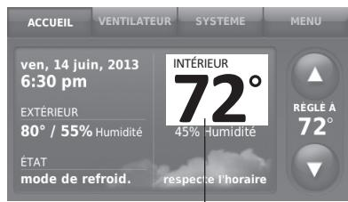
Les valeurs de température dépendent de l'emplacement du capteur.
