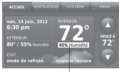
Les valeurs d'humidité dépendent de l'emplacement du capteur.
