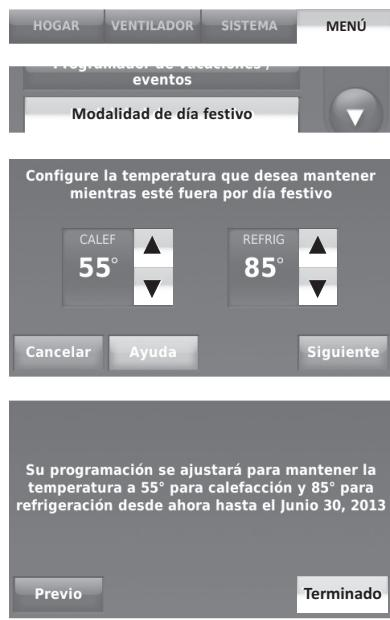
**NOTA:** La temperatura de refrigeración solo se puede establecer en un valor más alto que la configuración del programa del período desocupado y la configuración de la temperatura de calefacción solo se puede establecer en un valor más bajo que la configuración del programa del período desocupado.
